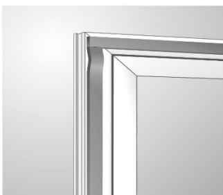
Fig. 1: Utforming av skjøter med fugebånd
